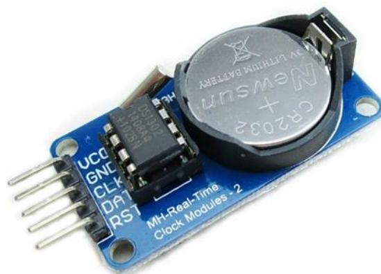
Рисунок 2 – Модуль часов реального времени
