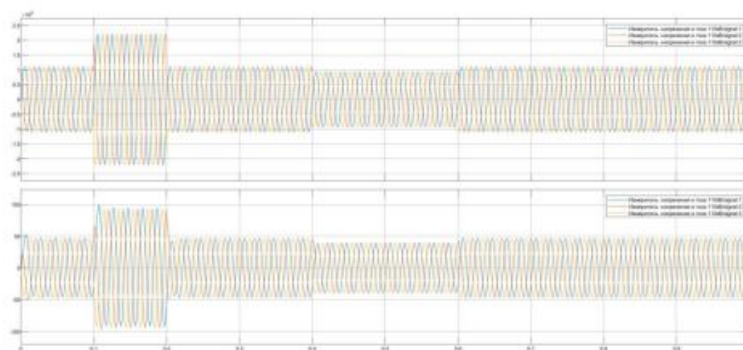
Рис. 4. Осциллограмма тока и напряжения на линии 220 кВ Т1 скачок и просадка напряжения
