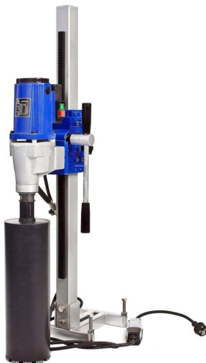
Рисунок 1 – Установка алмазного бурения
