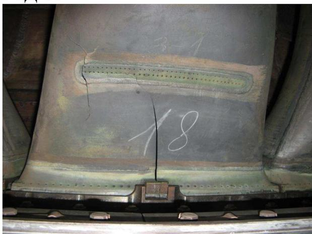
Рисунок 1 – Разрушение газосборника жаровой трубы
