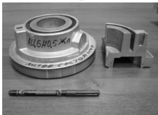
Рисунок 1 – Отливки «Опора» (а) и «Фланец» (б), полученные из сплава ЭЛАС (АЦ6Н0,5Ж) методом ЛКД
