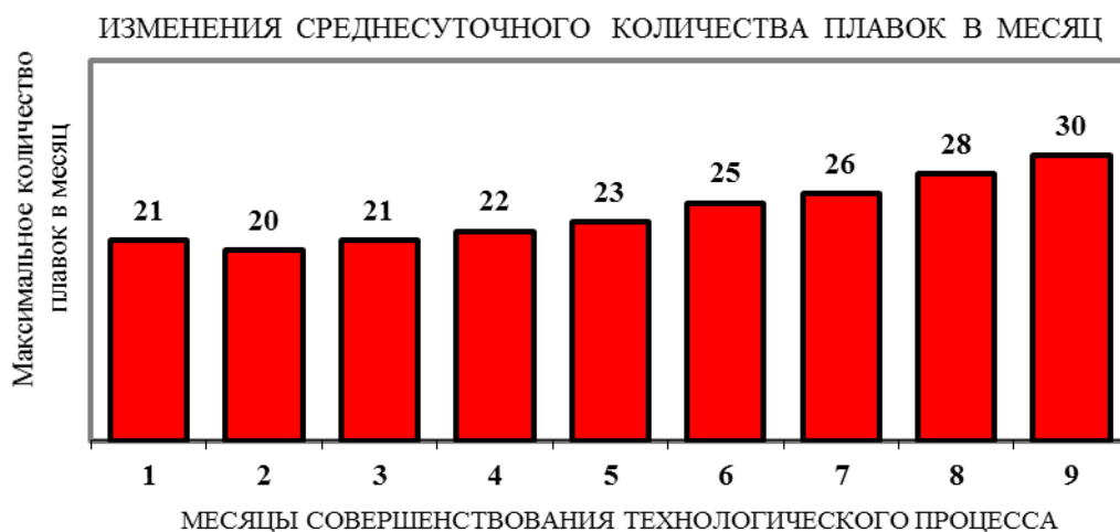
Рисунок 14 – Диаграмма среднемесячной производительности на электродуговой печи постоянного тока садко 150т., в результате оптимизации технологического процесса, использованием информации с системы Accusteel
