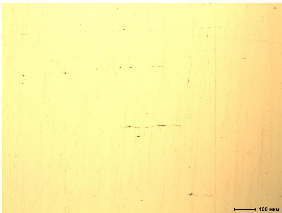
Рисунок 2 – Сульфиды балла 3 б в головке рельса
