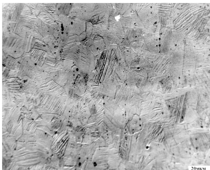
Рисунок 6 – Зеренная структура материала в центре заклепки
