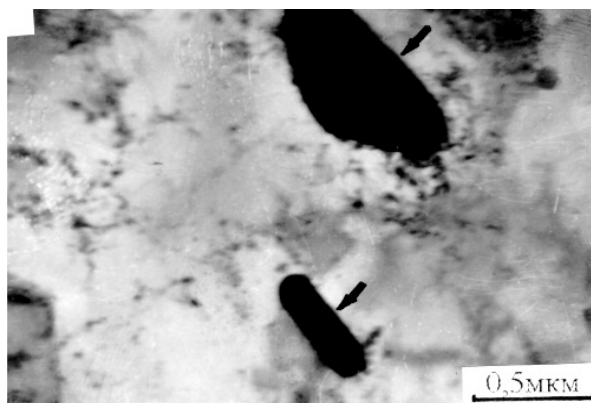
Рисунок 2 – Электронно-микроскопическое изображение тонкой структуры стали 08X18H10T (основной материал) вдали от заклепки. Стрелками отмечены частицы карбидов TiC
