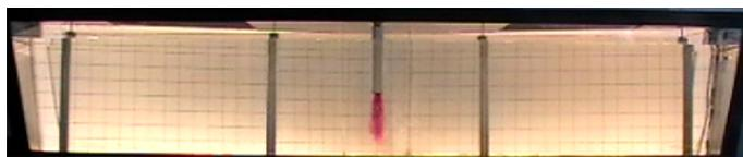
**Этап 2.** Ввод красителя при установившемся течении моделирующей жидкости
