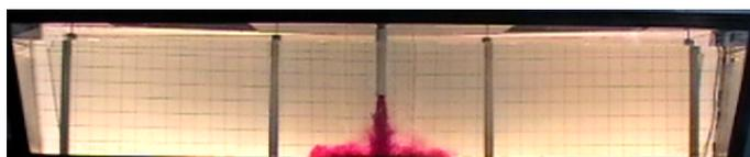
**Этап 3.** Видеосъемка распределения подкрашенной жидкости в объеме модели промежуточного ковша
