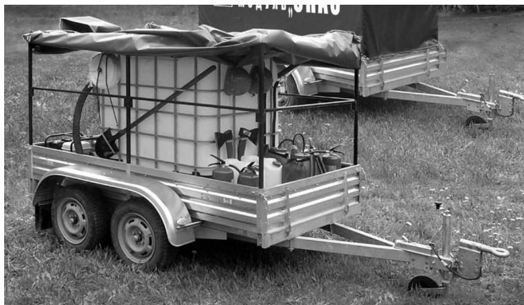
Рисунок 1 – Пожарный модуль «СПАС»
