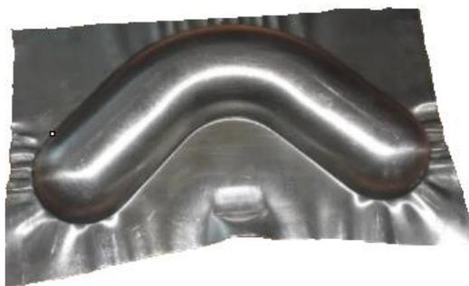
Рисунок 1 – Пример вытяжки листовой заготовки
