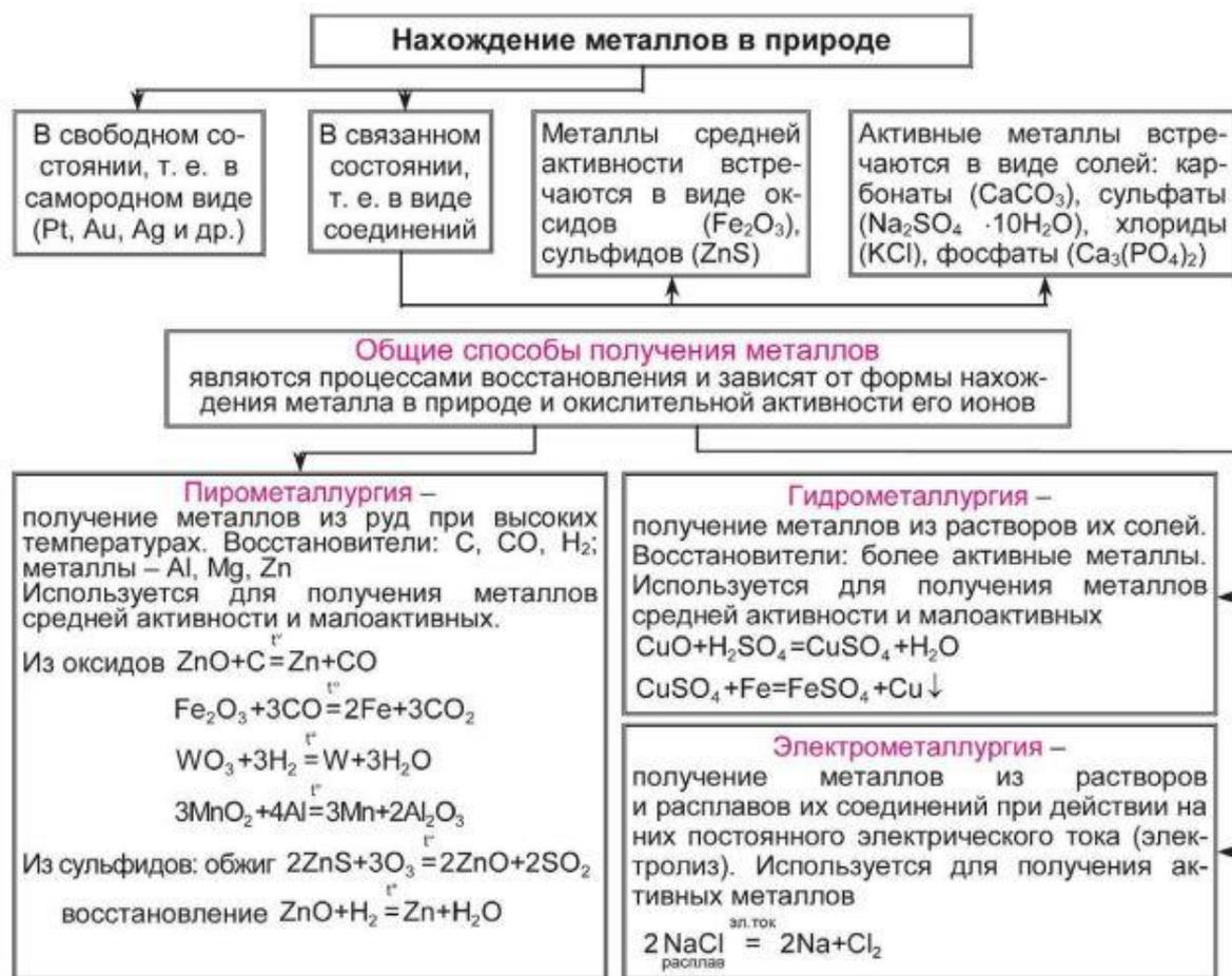
Рисунок 1 – Типичная схема экстракции металлов из руд
