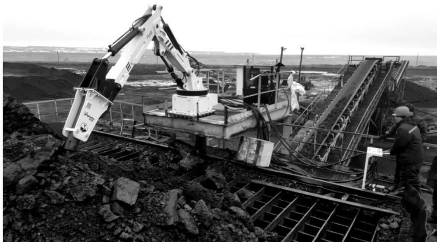
Рисунок 2 – Манипуляторная установка (бутобой) с гидромолотом в угольном разрезе
