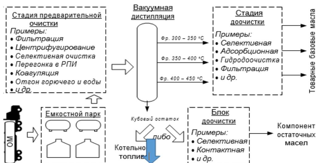
Рисунок 1 – Схема промышленной переработки ОММ
