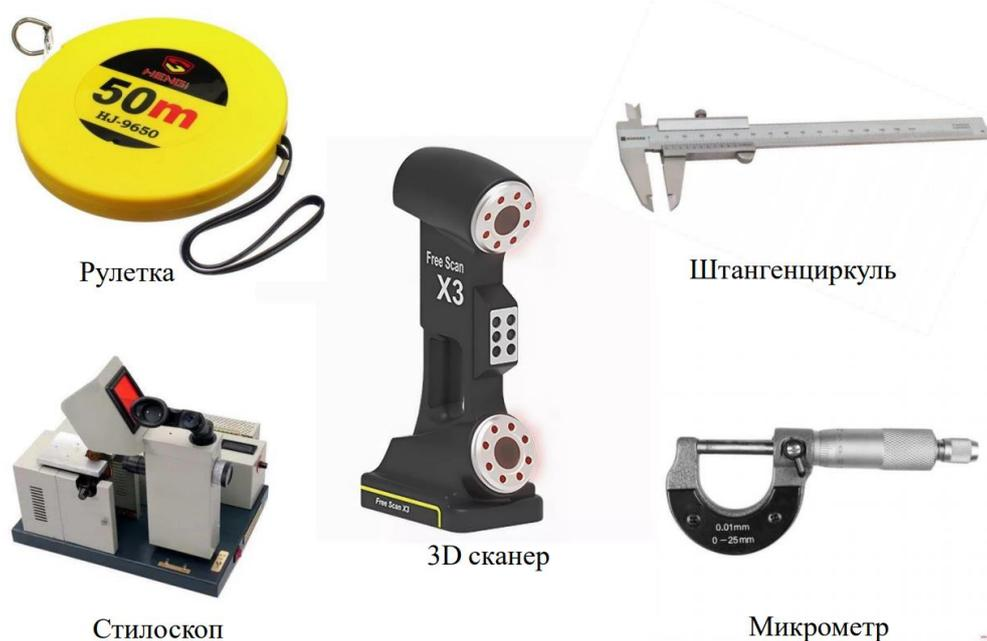
Рисунок 2 – Технические средства, входящие в состав комплекса
