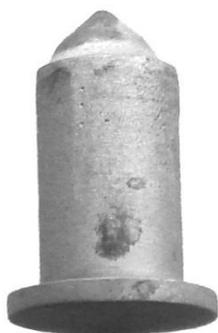
Рисунок 2 – Фотография индентора, используемого в приборе «Прочностномер ПСШ-1»
