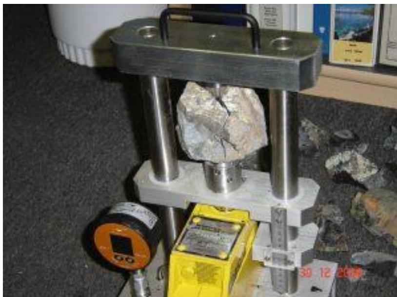
Рисунок 2 – Определение прочности горной породы методом точечной нагрузки [13]
