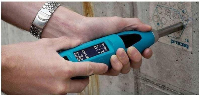
Рисунок 1 – Определение прочности бетона молотком Шмидта [9]
