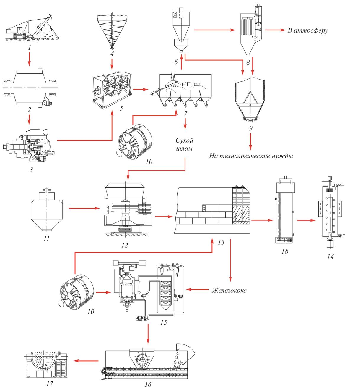
Рис. 1. Принципиальная схема процесса кондиционирования влажного конвертерного шлама адсорбционным обезвоживанием и термохимическим окучкованием:
