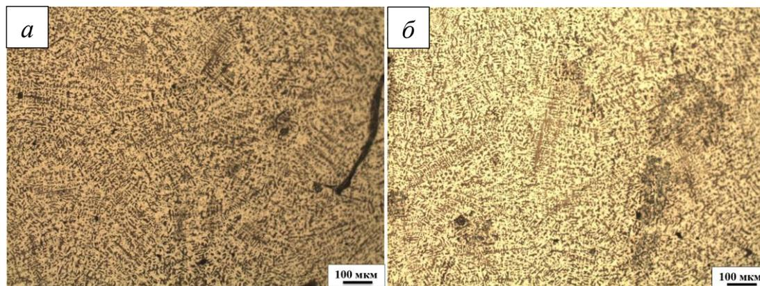
Рис. 1. Микроструктура наплавленного слоя P18Ю на расстоянии 2 мм (а) и 4 мм (б) от поверхности. Световая микроскопия
