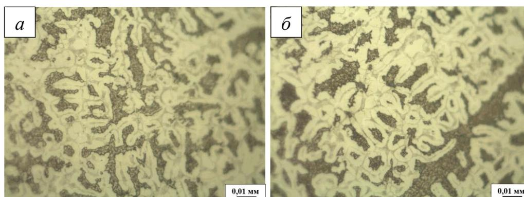
Рис. 2. Микроструктура наплавленного слоя P18Ю на расстоянии 2 мм (а) и 4 мм (б) от поверхности. Световая микроскопия
