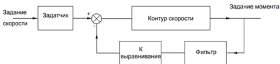
Рисунок 5 – Принцип выравнивания нагрузки
