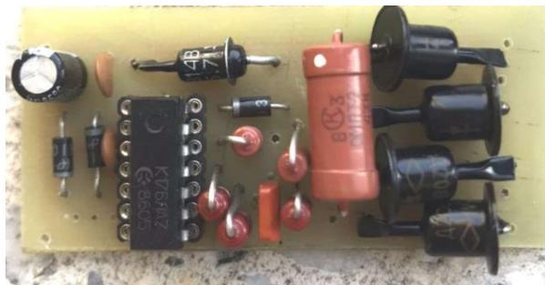
Рисунок 4 – Регулятор мощности паяльника в сборе
