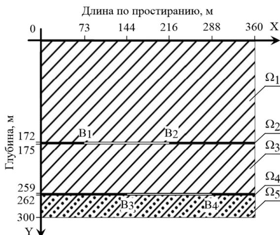
Рис. 2. Расчетная область участка геомассива, включающего очистные выработки на сближенных угольных пластах
