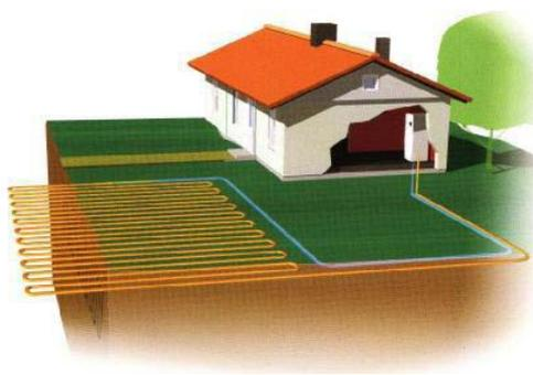
Рис. 2 – Тепловой насос, использующий тепло грунта
