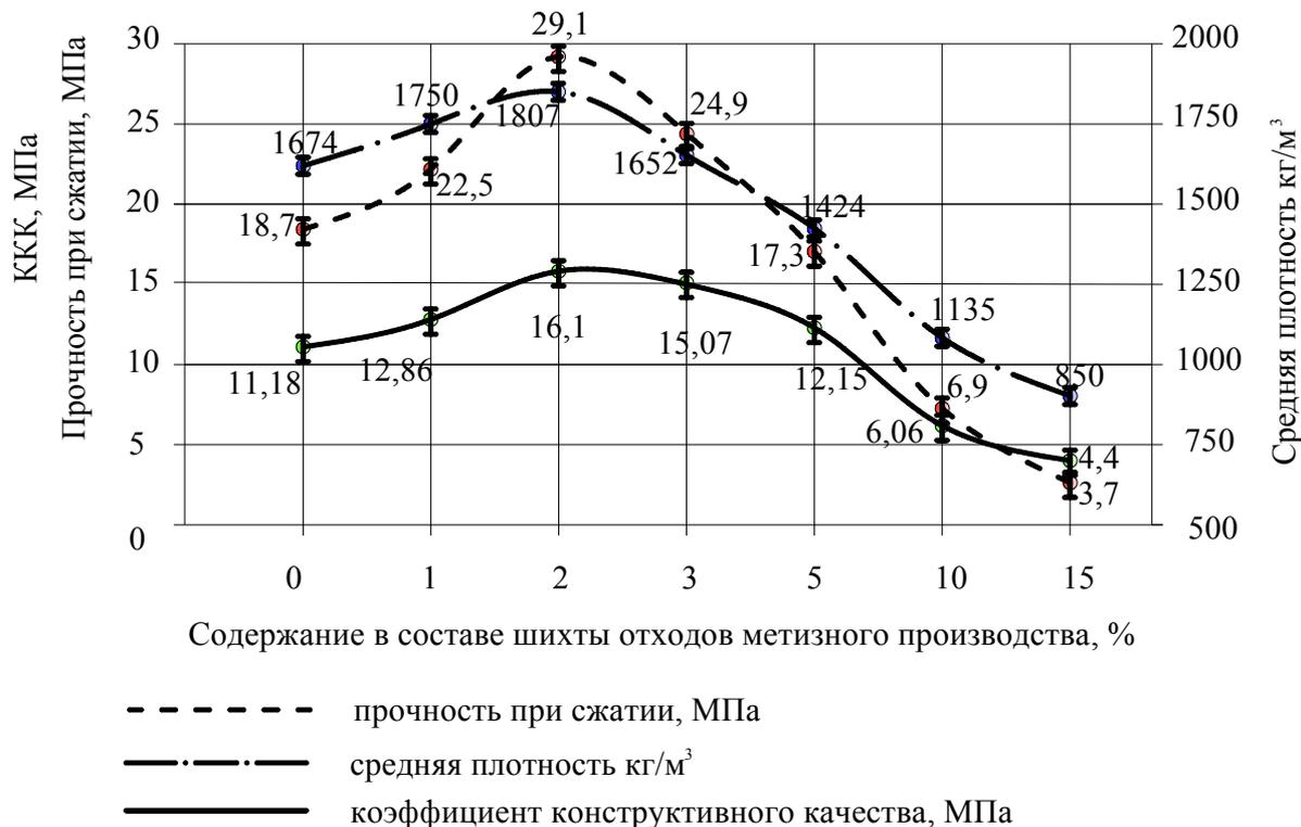
Рис. 1. Влияние добавки отходов метизного производства на свойства керамических образцов на основе отходов углеобогащения
