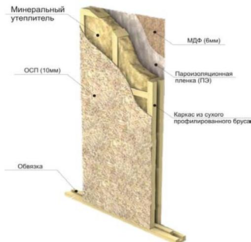
Рис. 7. Фрагмент наружной стены каркасно-панельного дома
