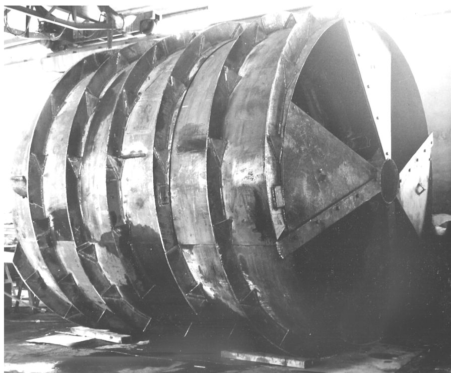
Рисунок 2 – Экспериментальный образец геогода ЭЛАНГ-3 диаметром 3м
