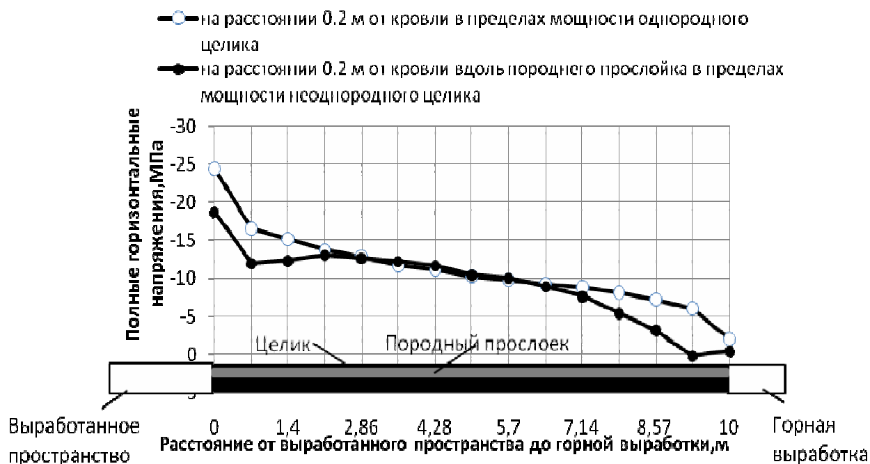
Рисунок 3 – Распределение напряжений по ширине целика
