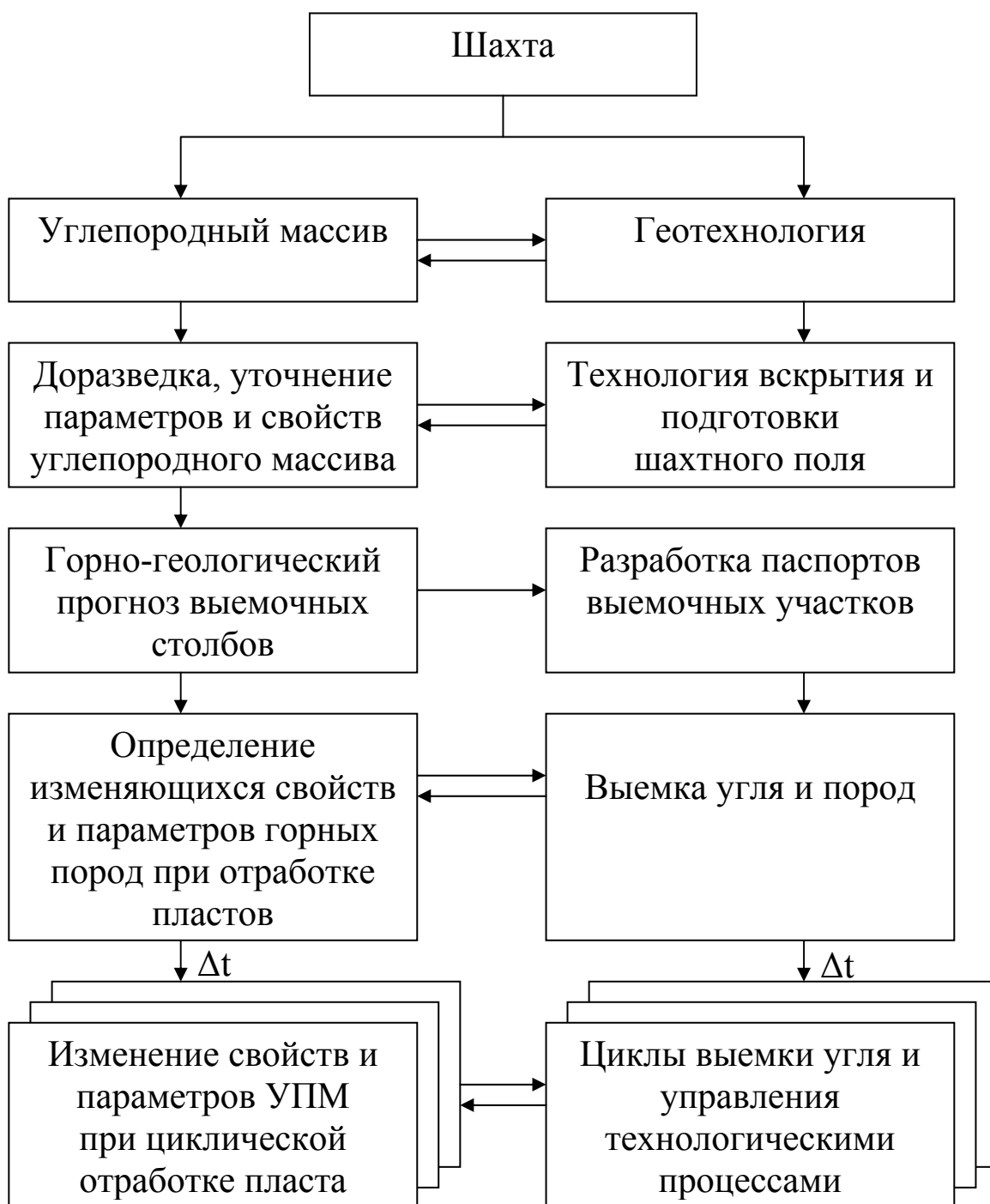
Рисунок 2 - Схема взаимодействия в углепородном массиве геомеханических, газодинамических и техногенных процессов с учётом пространственно-временного изменения свойств пород и положения системы очистных и подготовительных забоев
