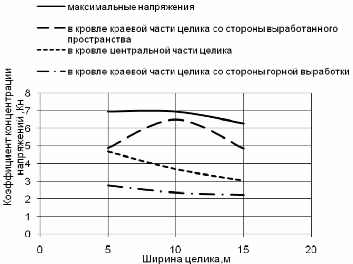
Рисунок 2 – Закономерность распределения полных вертикальных напряжений в зависимости от ширины целика
