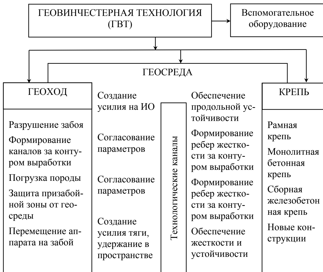
Рисунок 1 – Структура геовинчестерной технологии проведения горных выработок
