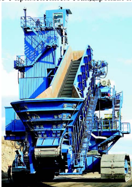
Рисунок 2 - Приемный бункер и борта питателя, футерованные плитами из высокопрочной стали XAR® 400
