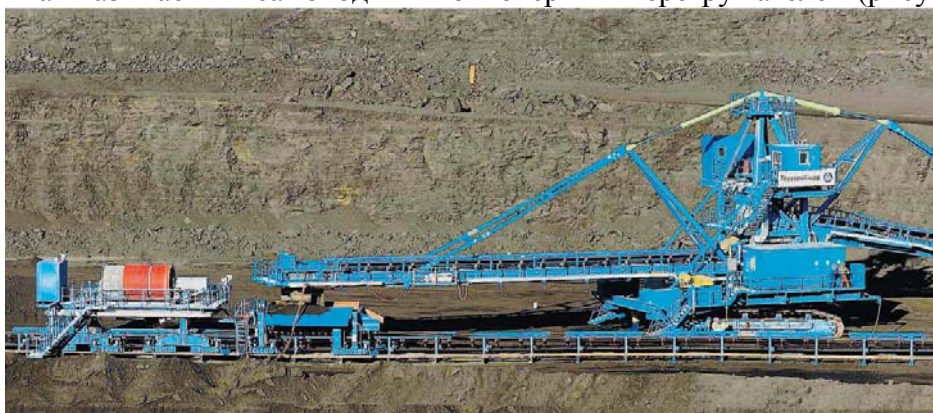
Рисунок 3 - Канатный экскаватор – полностью мобильная дробилка – конвейерный перегружатель – конвейер
