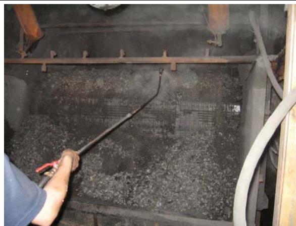
Рисунок 7 - Выгрузка кокса. Контроль и тушение горячих зон
