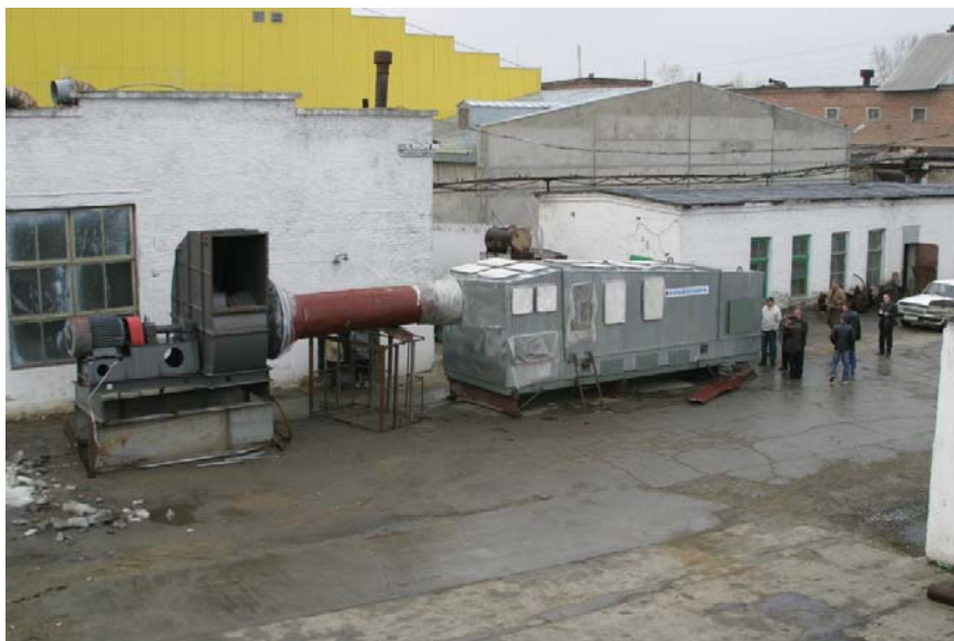
Рисунок 6 - Установка взрывозащиты СВГС на заводских приемочных испытаниях
