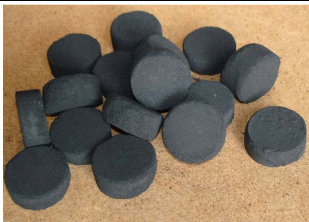
Рисунок 1 – Брикеты 12x18 мм из полукокса
