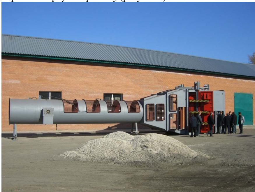
Рисунок 9 - Приёмка СВГСА зав. 1 дегазационной установки ЗУВЦГ – 15
