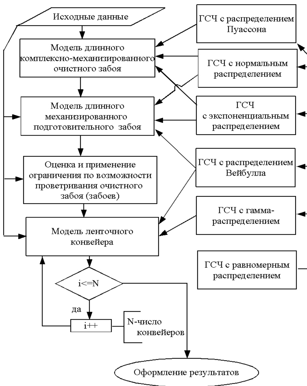
Рисунок 1 - Укрупненная структурная схема модели технологической схемы шахты
