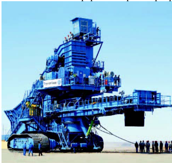
Рисунок 1 - Полностью мобильный дробильный комплекс для открытого угольного разреза в Китае
