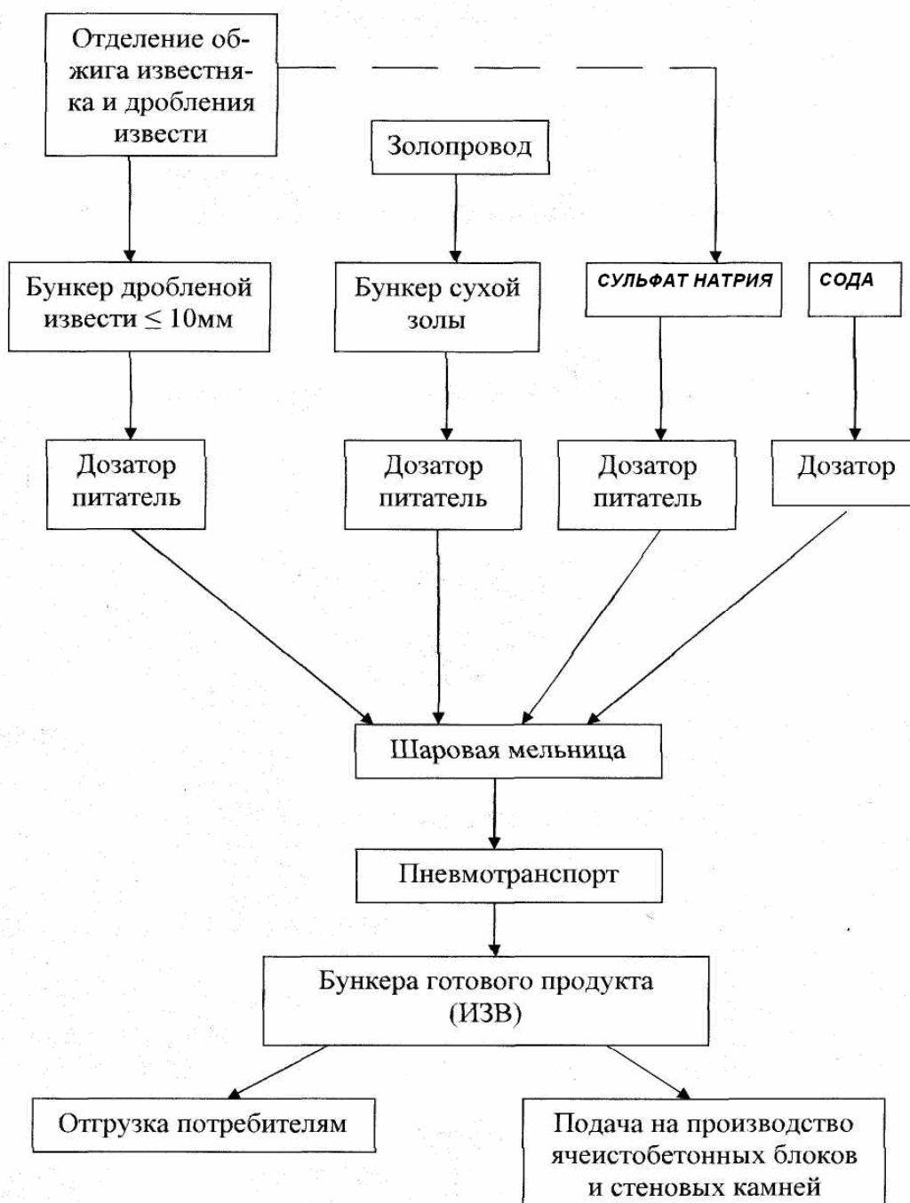
Рисунок 1 – Технологическая схема производства известково-зольного вяжущего
